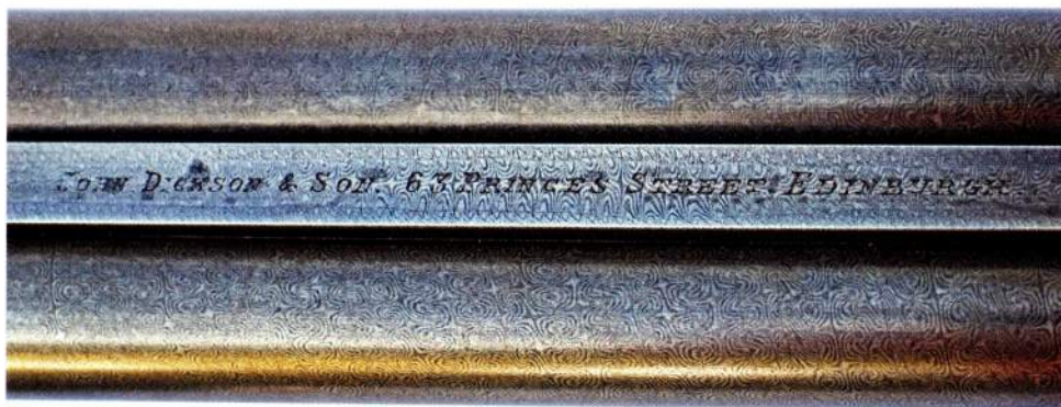
Damascus-lobene er vredet eller viklet stål. Og her ses tydeligt de mønstre, som kommer frem og giver en meget smuk overflade. Konkav sigteskinne med Dickson-navn og -adresse.
