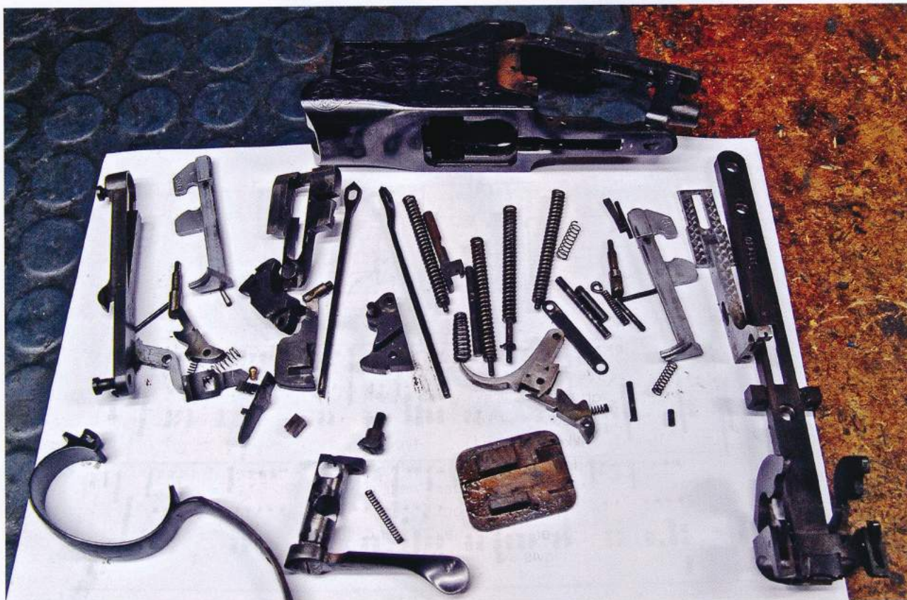
På bøsse-magerens arbejdsbord: en totalt adskilt over-/under-lås og baskyle. Der er mange dele på trods af, at denne lås kaldes den enkle og simple. God systematik er påkrævet: Don't do this at home!
