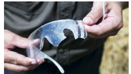
Den klare brille, som tidligere blev udleveret fra Dansk Jagtforsikring, dumpede med et brag. Ikke alene holdt den ikke til testen, men dens venstre glas splintredes.
