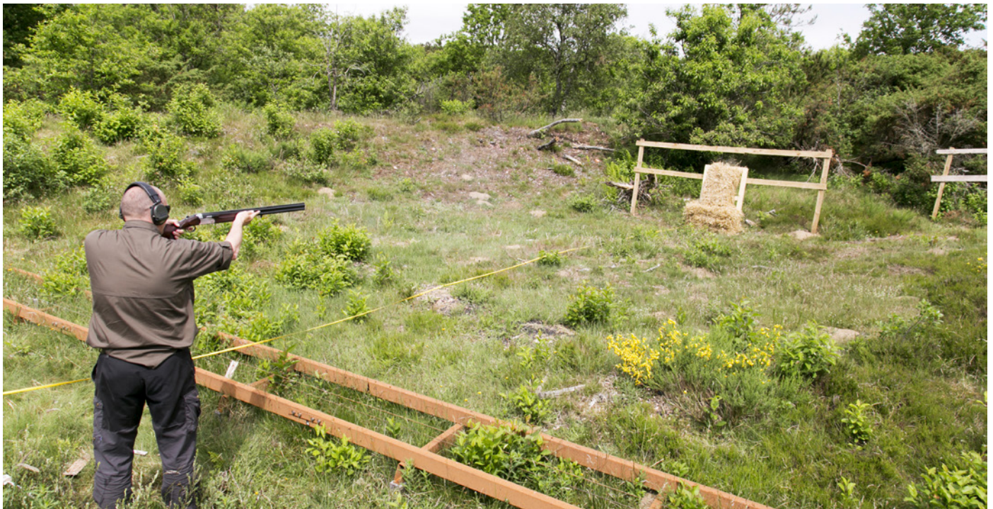
Alle brillerne blev testet ved at blive påskudt på 10 meters afstand med en flugtskydningspatron haglstørrelse 7. Brillerne var anbragt på en "næsekrog" på halmballen i baggrunden.
