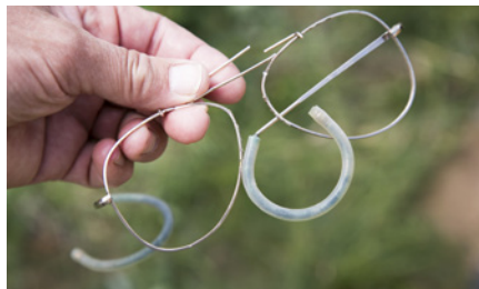
Sådan så "Bushnell Impact Resistant Shooting Glasses" ud efter testen ...
