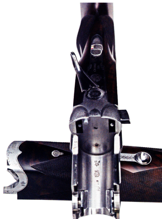
Låsens "tunge" del er i et stykke børstet stål. Sidepladerne med fjedrene er koblet på bagkanten af blokken. Her ses også tydeligt bundhængslingen uden tværbolt, men også befæstningerne i toppen til de to lukkeknaster og Greener-bolten i siden.
