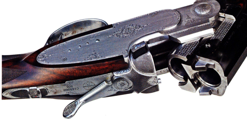
Det er tydeligt, at SO5-konstruktionen adskiller sig fra den mere almindelige Beretta-konstruktion. Bemærk de dobbelte lukkeknaster og den tværgående Greener-bolt. En af de mest sikre låsekonstruktioner i over/undere.
