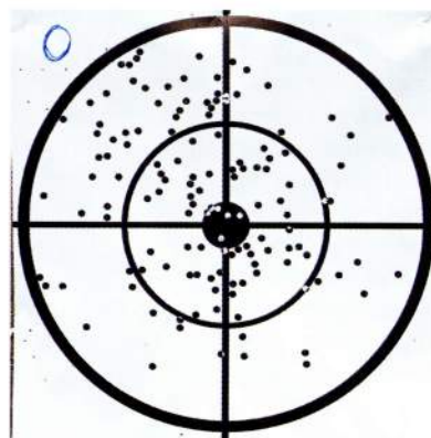
På skiven til venstre ses fordelingen af hagl med en kaliber 12 Guerini Figura og 1/4 boring på 25 meter. På billedet til højre, samme afstand, samme boring, men en Beretta Silver Pigeon i kaliber 20. Der er ikke megen forskel, og ved praktisk skydning og jagt vil jeg påstå, at forskellen er betydningsløs.
