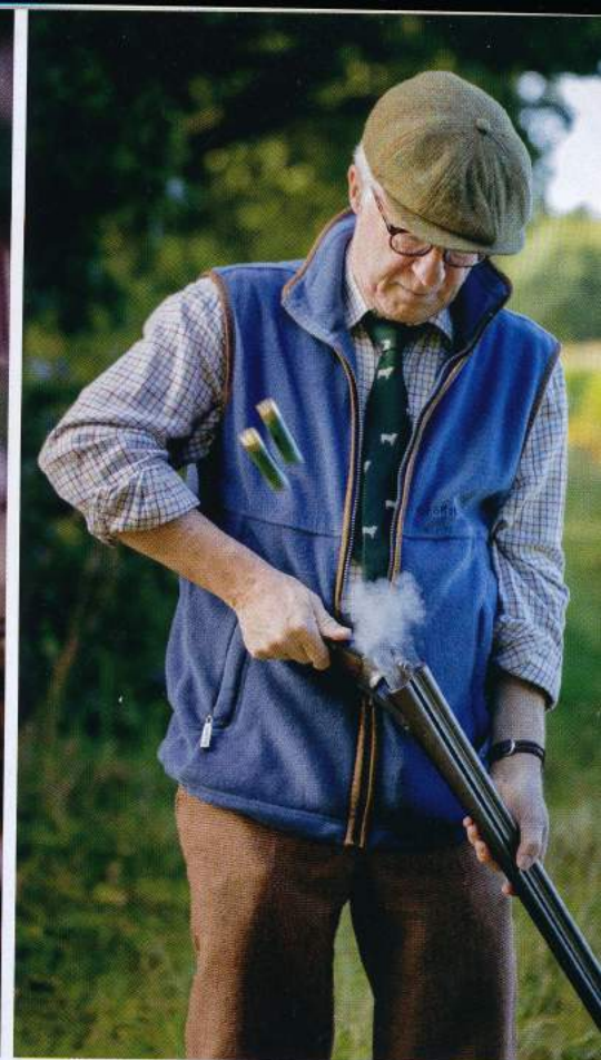
Denne Westley Richards fra 1892 er speciel, fordi den bl.a. er en af de første med single-aftrækker. Den har Westley Richards' eget ejector-system, og det virker den dag i dag, som det kan ses.w
