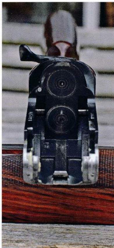
Den lave låsekonstruktion i ét stykke og med tykke vægge, som det ses, er med til at sikre mange tusinde skud uden slid. En ekstra finesse er, at slagstifterne trækkes tilbage, så der ikke slides på dem.
