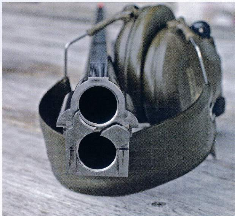
Perazzis løb er i højeste kvalitet. Monobloc med forkromning indvendig. Ikke så usædvanlig, men det er derimod det arbejde der er lagt i sammenføjning og finish. Bred sportsskinne med fiberkorn i enden.
