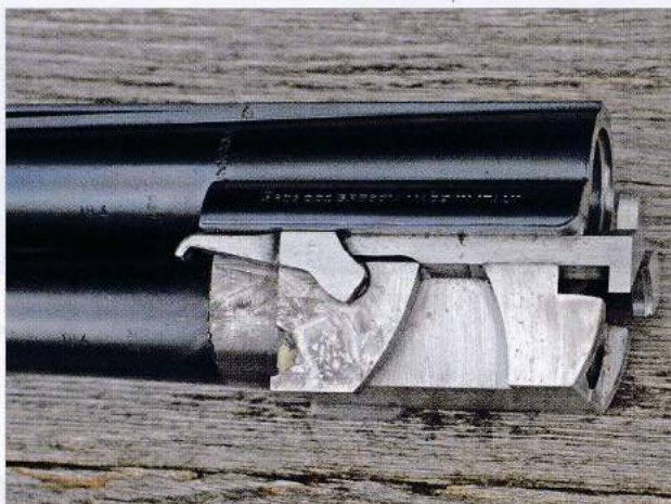
Kammerdelen på løbene, hvor man igen kan se, at der er lagt mere vægt på styrke og holdbarhed end ønsket om at smide nogle gram på vægtskålen. Ejektorerne betjenes af fjedre i forskæftet.
