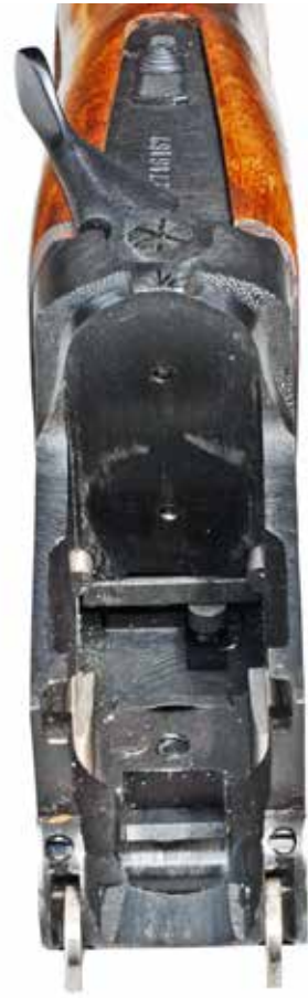
En "gammeldags" låsekasse med tydelige referencer til Browning og ikke de smarte italienerne. Her er der tværbolt og solid bundplade. Ikke helt afpudset, men en ægte Baikal.
