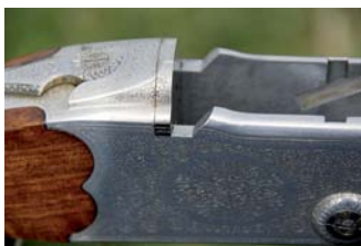
De trapetsoida klackarna föregås av en liten valk. Inte så betydelsefullt för hållfastheten men linjerna blir enormt mycket snyggare på vapnet.
