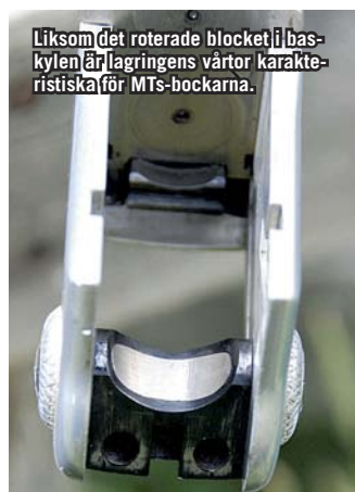
Det roterande och lagrade blocket i basylen.
