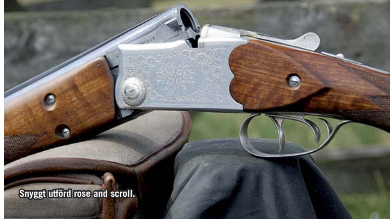
Förstockens delar sitter monterade direkt på piporna med tre skruvar. Dragna på linje naturligtvis.
