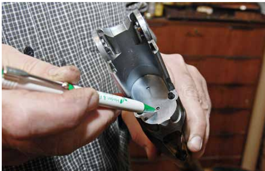
Mange købere undlader at tjekke slagstifterne på et brugt gevær. Her peger bøssebager Per Langvad på den vigtige detalje.
